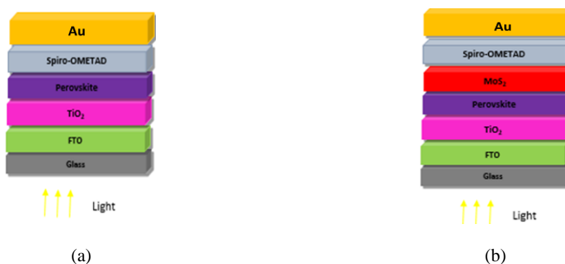
Figure 1. Device structure, (a) FTO/ TiO_2 / CH_3NH_3PbI_3 /Spiro OMERTAD, (b) FTO/ TiO_2 / CH_3NH_3PbI_3 / MoS_2 /Spiro-OMERTAD
